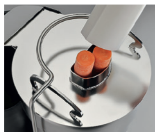
Rotor Vitamat Inox H avec goulotte semi-circulaire
